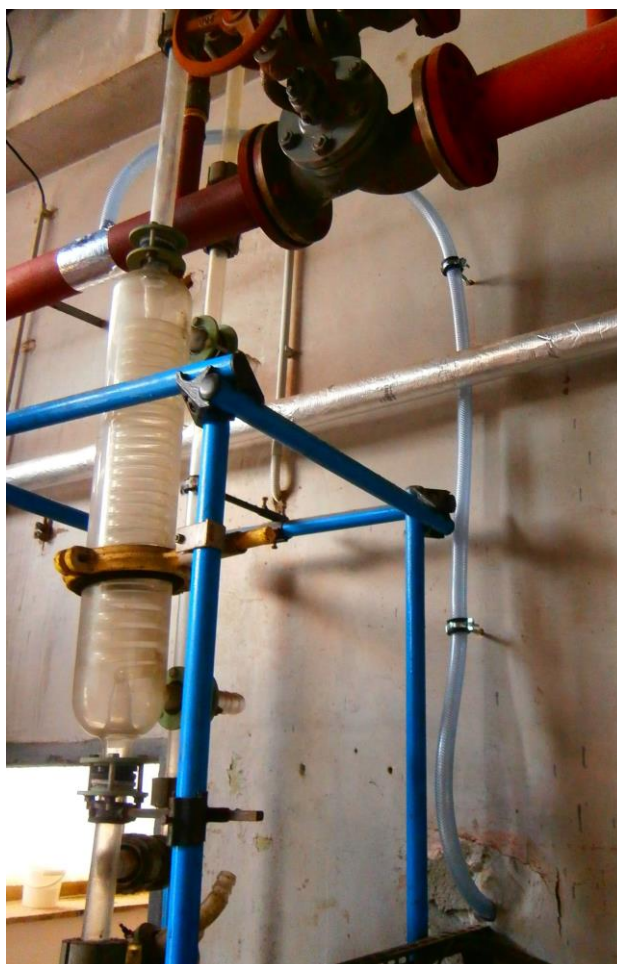
Přivedení tlakové hadice ze zařízení Smellmeister ® 80G k výtlačné trysce
